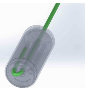
Par cordeau détonant
